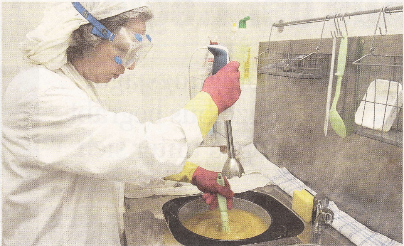
In ihrer Seifenküche macht sich Regine Bär in Schutzkleidung ans Werk. Sie verrührt geschmolzene Fette und flüssige Öle so lange mit einer Lauge, bis sich im Topf eine puddingähnliche Masse bildet, die dann in die Seifenformen gegossen wird.
